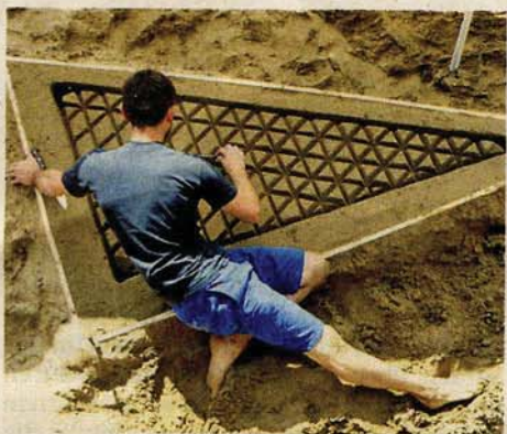
Der britische Designer Max Lamb stellt eine Gussform aus Sand her. FOTO: OH
